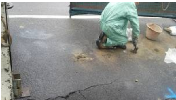
Variante per prelievo “top soil” su pavimentato
